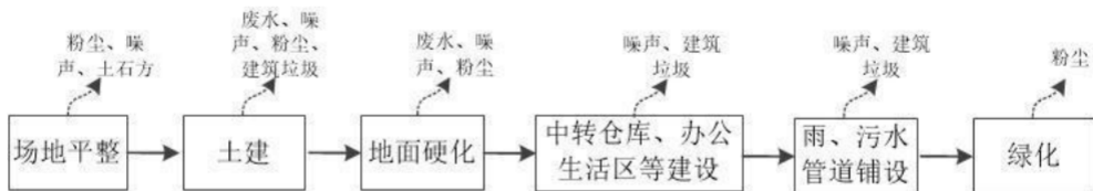
图 2-2 项目施工期工艺流程及产污节点图
